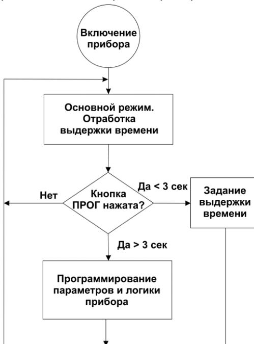
Рис. 4.1. Блок-схема доступа к элементам меню прибора
