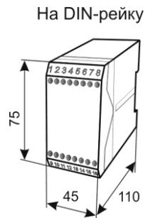
Рис. 6.3 Корпус для крепления на DIN-рейку
