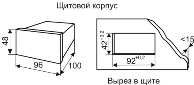
Рис. 6.1 Щитовой корпус
